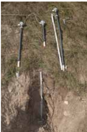
Bodenfeuchtsensoren (Tensiometer), Untersuchung verschiedener Bodentypen (Landnutzung).
