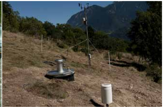
Das Lysimeter misst Versickerungsrate, Verdunstung.
