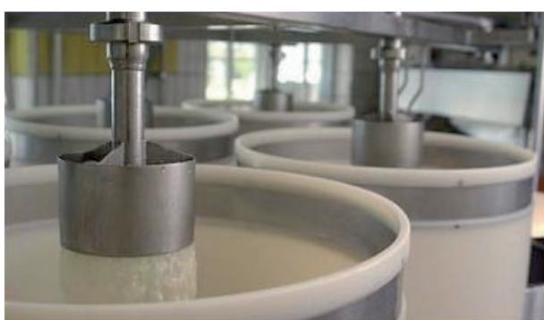
**Abb. 3:** Die Bruchkörper werden in Järbe abgefüllt
