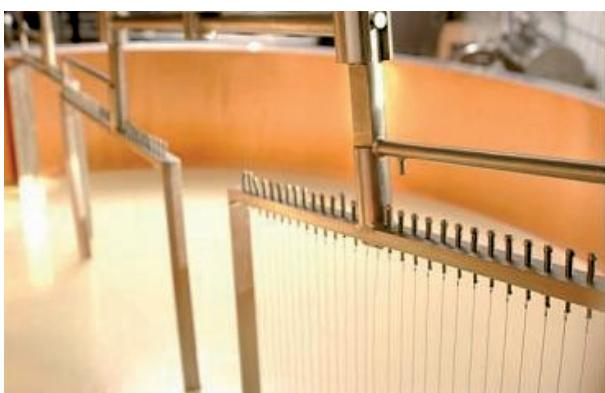
**Abb. 2:** Die Käsemasse wird mit der Harfe zerschnitten
